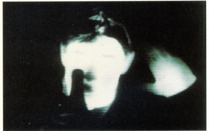
Augenpartien. Die emittierte Strahlung wird vom Glas reflektiert. Somit erscheint die (hinterlüftete) Brille kalt.
