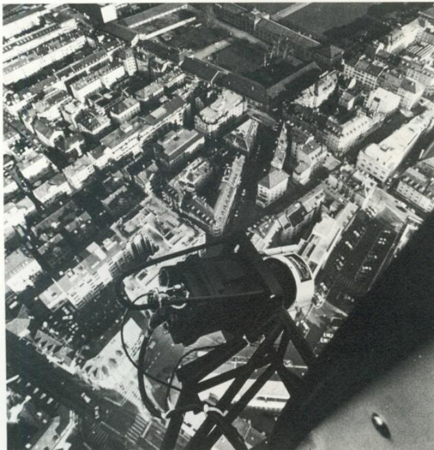
Thermale Scanner sind komplizierte und extrem teure Geräte. Sie kosten zwischen sFr. 200'000.- und 900'000.- und haben mit normalen Kameras nichts gemeinsam. Die in Zürich eingesetzten Geräte repräsentieren eine neue Generation von Technologie: Sie verfügen über eine rund 20mal grössere Abtastgeschwindigkeit und eine fast 10mal bessere räumliche
