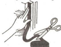
wie etwa einen Profilmgummi-Abdichtungsstreifen aus Moosgummi oder einen Keildichtungsstreifen. Die billigen Kunststoffstreifen sollten nur für Fenster benützt werden, die selten geöffnet werden. Beim Abdichten ist besonders auf die folgenden Punkte zu achten:
